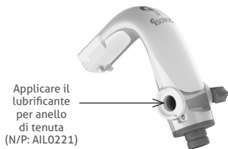
Figura 11. Anello di tenuta da lubrificare
