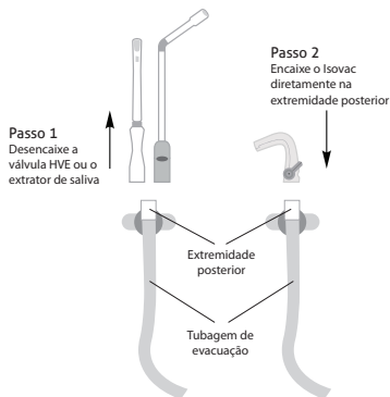
Figura 1. Instalação sem conector
