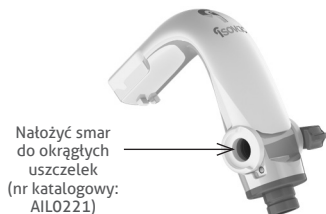
Rysunek 11. Smarowanie pierścienia ustalającego
